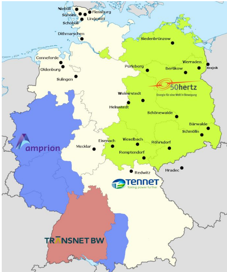
Abbildung 3: Regionale Verteilung von überlasteten Betriebsmitteln die zu Einspeisereduzierungen durch Maßnahmen nach § 13 Abs. 2 EnWG oder § 13 Abs. 2 EnWG i.V.m. § 11 Abs 1 EEG im Winter 2011/2012 geführt haben. 2
