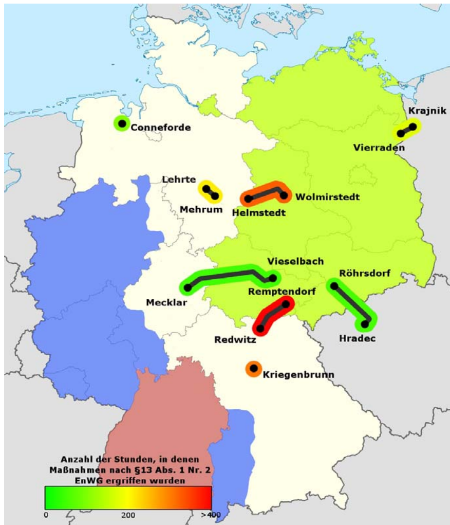
Abbildung 2: Grafische Darstellung der Netzelemente zu deren Entlastung die meisten Redispatchmaßnahmen im Winterhalbjahr 2011/12 durchgeführt werden mussten. Quelle: Maßnahmenscharfe Datenerhebung der BNetzA bei den deutschen ÜNB, Grafik: BNetzA 1
